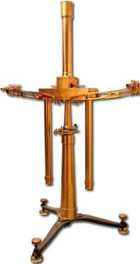
Eötvös torsion balance (Eötvös pendulum)
